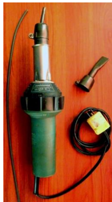
FIGURA 5. SOLDADOR Y VARILLA DE PVC.
